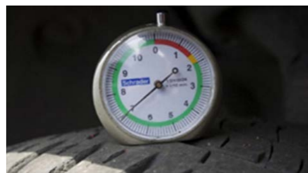
Гуми: Дълбочина на протектора \geq 5 mm (СЪОТВЕТСТВА) Забележка: Дълбочината на протектора се измерва в най-износения канал на гумата.
