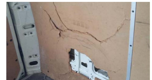
Вътрешни дървени предпазни елементи: Следи от удари, скъсани панели, липсващи панели (с изключение на горните панели на вратите)
