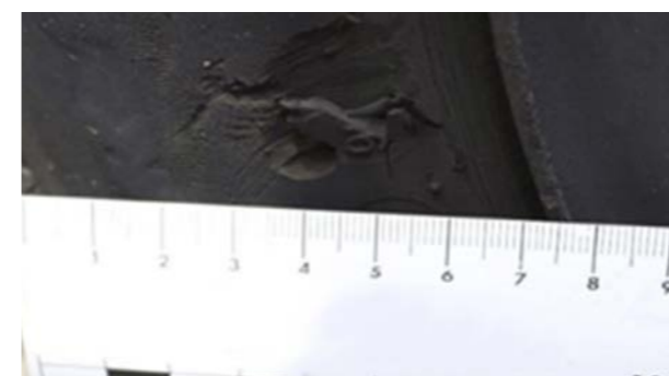
Гуми: Прорез с дълбочина > 3 mm, отстраняване
