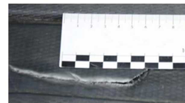
Перфориране на твърд пластмасов облицовъчен елемент. Ремонтът на твърди пластмасови облицовъчни елементи се извършва за 1 час по фиксирана тарифа, ако е възможен и приемлив от естетична гледна точка
