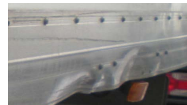
Странични профили на долната част на каросерията: деформации, чийто ремонт не е икономически изгоден, пробиви, липсващи части от профила
