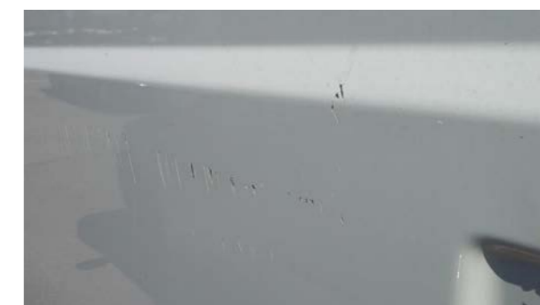
Драскотини > 20 mm ЗАБЕЛЕЖКА: На задния канат не е възможно да се боядиса само половината панел
