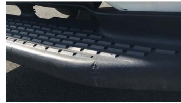
Задно стъпало: Деформации, чийто ремонт е икономически изгоден
