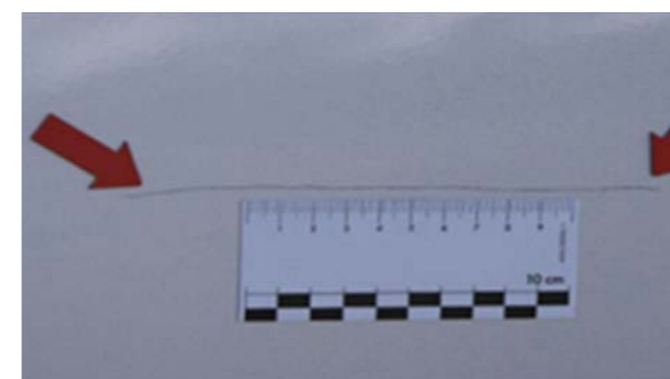
Драскотини > 20 mm ЗАБЕЛЕЖКА: На задния канат не е възможно да се боядиса само половината панел
