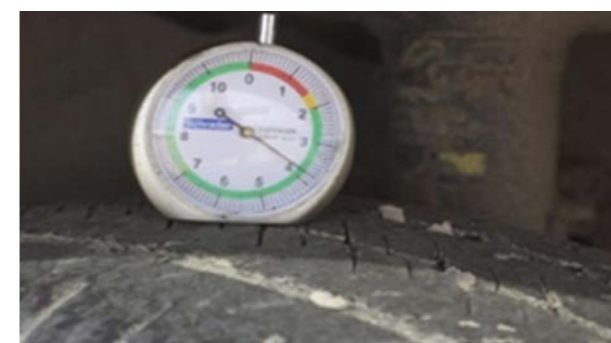
Гуми: Базова дълбочина на протектора < 5 mm Забележка: Дълбочината на протектора се измерва в най-износения канал на гумата.
