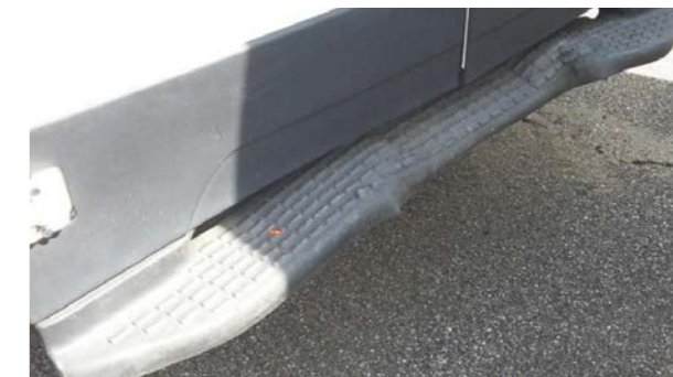
Bagerste platforme: Deformationer, som ikke kan betale sig at reparere
