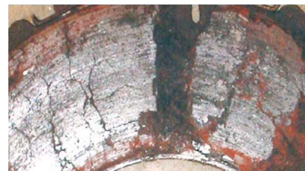
Rustne, nedsløbne, slidte bremseklaver
