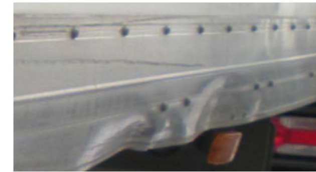
Undervognens sideprofiler: Deformationer, som ikke kan betale sig at reparere, huller, afmontering af en del af profilen
