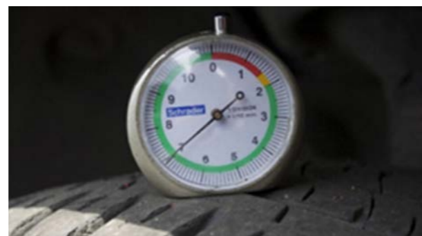
Dæk: Basis for rillens dybde \geq 5 mm (OVERENSSTEMMENDE) Bemærk: Slitagen af dækket måles i den mest slidte rille på dækket.
