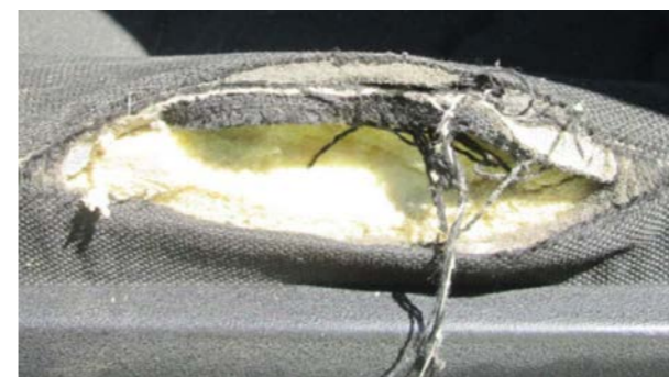
Manglende skum eller brudt sæderamme
