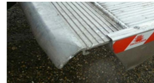
Læssesmæk: Deformationer af platform, som kan betale sig at reparere
