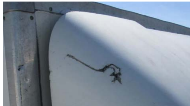
Frembygget førerhus og Tagspoiler: Som kan betale sig at reparere
