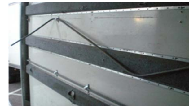
↻ Indtræk og stænger: Manglende eller deformerede stænger, fastgørelser, indtræk, som ikke kan betale sig at reparere
