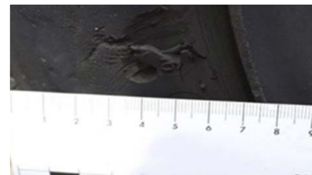
Dæk: Hak > 3 mm dybt, afmontering
