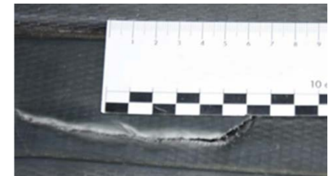
Perforation des garnitures en plastique dur. Réparation des garnitures de plastique dur forfait 1h si esthétiquement acceptable et reparable
