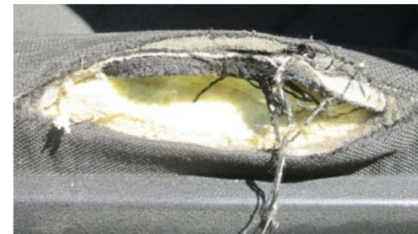
Manque de mousse, ou structure cassée
