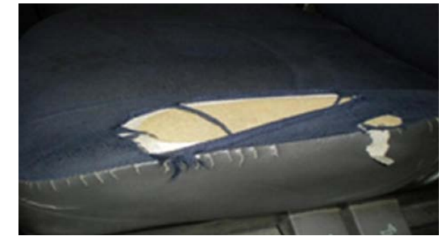
Brulure > 3 mm ou perforation ou déchirure de la coiffe sans détérioration de la mousse
