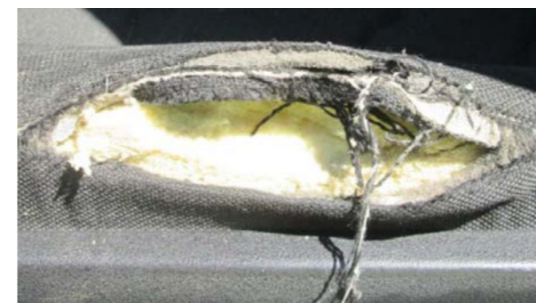
Pjena nedostaje ili je okvir razbijen
