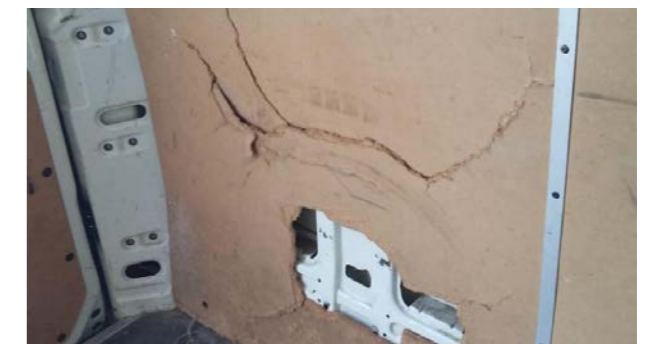
Wewnętrzne osłony drewniane: Ślady uderzeń, rozdarty panel, brak panelu (nie dotyczy górnych paneli drzwiowych)
