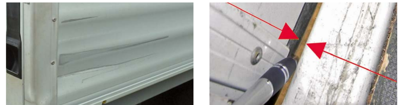
🔄 Odształcenia szyn, których naprawa jest nieopłacalna, zamknięcie niemożliwe lub nie jest piaskoodporne
