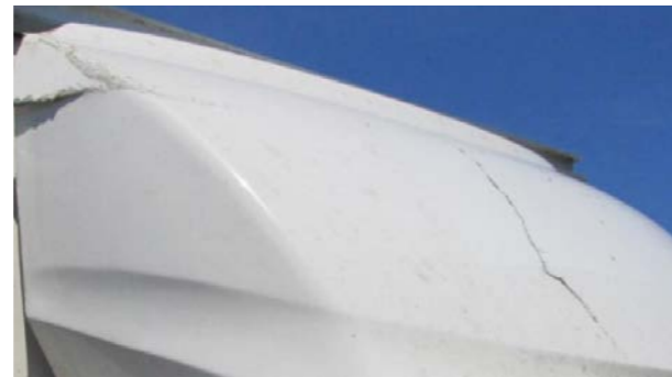
Cabina sobre o motor e defletor: fissura significativa, peça em falta ou que excede a reparação económica
