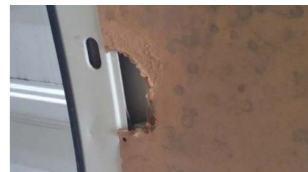
Proteções internas de madeira: impactos, painel rasgado, painel em falta (excluindo os painéis superiores das portas)
