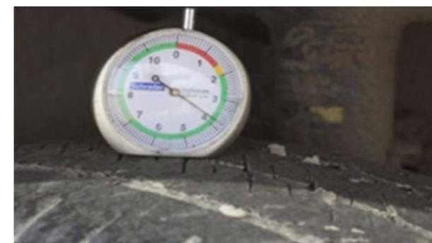
Pneus: base da ranhura, profundidade < 5 mm Nota: o desgaste dos pneus é medido na ranhura mais gasta do pneu.
