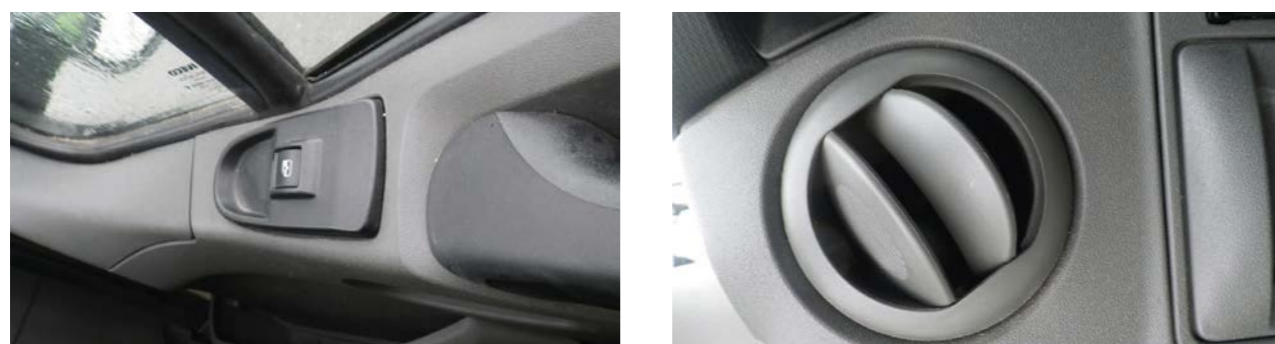
Descoloração ligeira devido aos raios de sol
