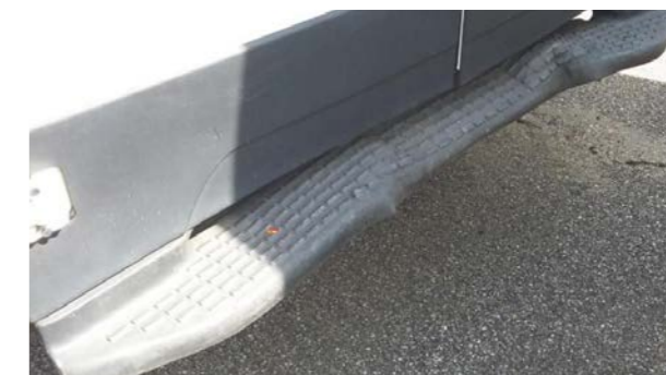
Plataformas traseiras: deformações fora da reparação económica
