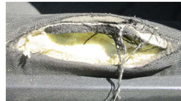
Falta da espuma ou estrutura partida
