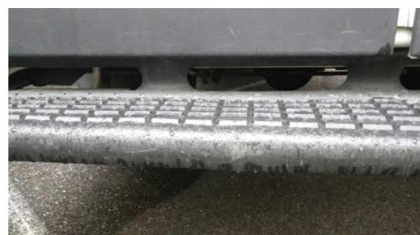
Riscos ligeiros na pintura, nas arestas de carga
