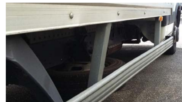
Suportes para bicicletas: deformação dentro da reparação económica
