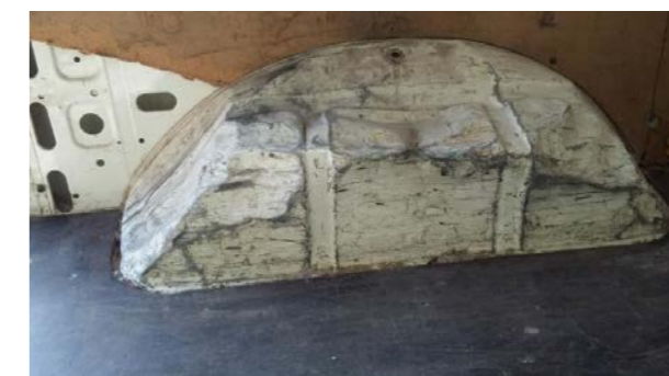
Deformações internas: perfurações, cortes, deformações que excedem a reparação económica. Desnaturação e depósito incorrigível (pó, tinta, etc.) (Cava da roda não recuperável se o tempo de reparação for < 3h)
