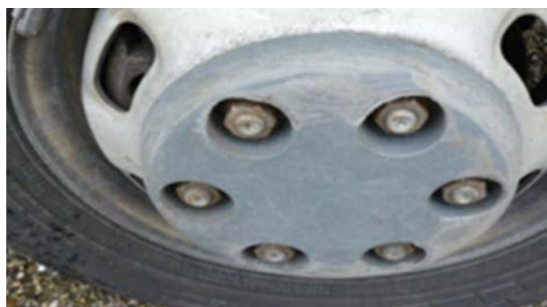
Jantes e tampões das rodas: múltiplos riscos superficiais com ou sem remoção de material
