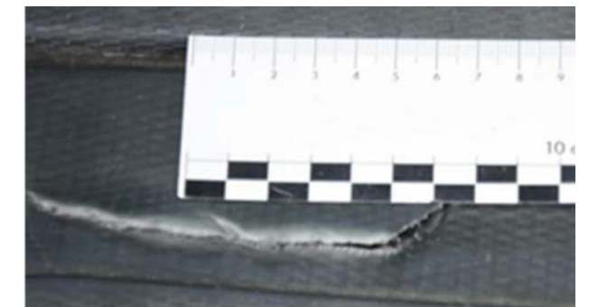
Perfuração de revestimentos de plástico duro.
