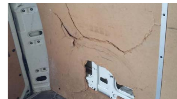
Proteções internas de madeira: impactos, painel rasgado, painel em falta (excluindo os painéis superiores das portas)
