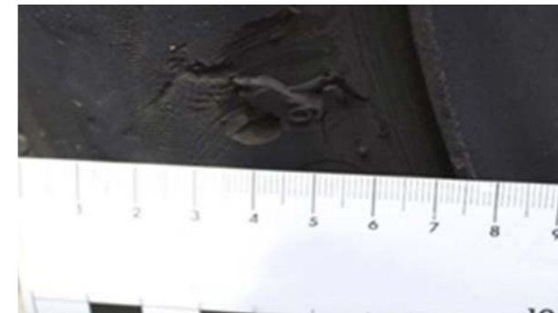
Pneus: entalhe > 3 mm de profundidade, remoção
