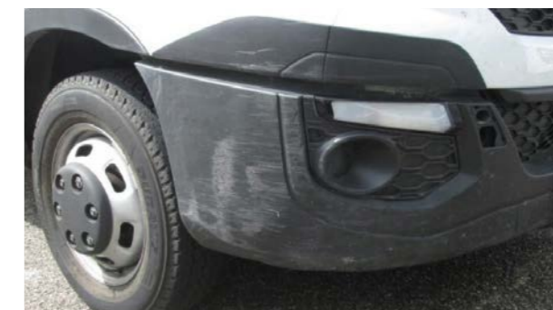
Remoção de material ou deformação com reparação viável ou económica
