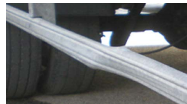
Suportes para bicicletas: deformação que excedem a reparação económica
