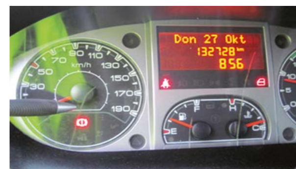
Riscos no painel de instrumentos combinado e outros danos visuais ou orifícios no campo de visão
