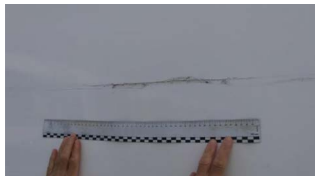
Painéis laterais: risco com remoção de material \geq 20 cm dentro da reparação económica. Opção de pintar metade do painel
