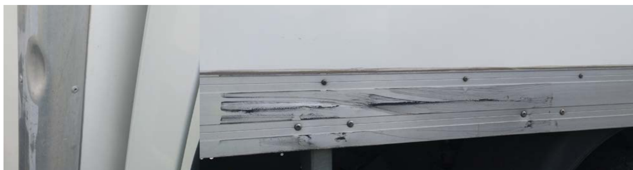
Bočni profili trapa: Deformacije u okviru ekonomične popravke
