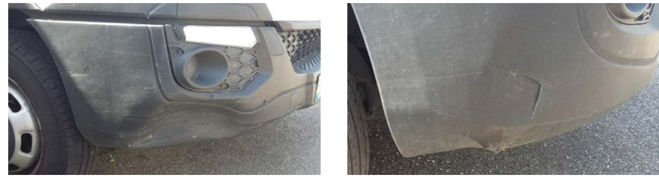
Pokvareno, uklanjanje materijala ili deformacije nije izvodljivo ili ekonomično za popravku
