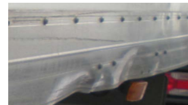
Bočni profili trapa: Deformacije za koje nije moguća ekonomična popravka, perforacije, uklanjanje dela profila
