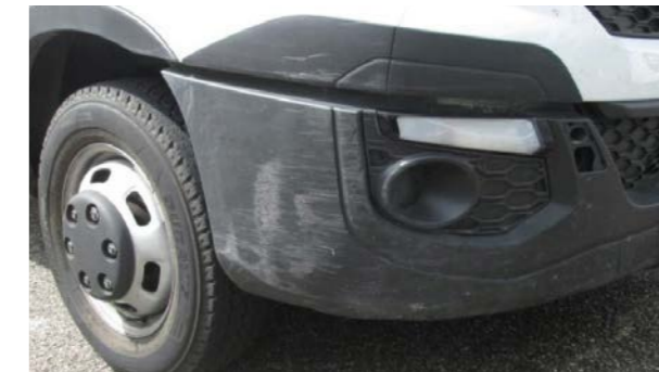
Uklanjanje materijala ili deformacije izvodljivo ili ekonomično za popravku
