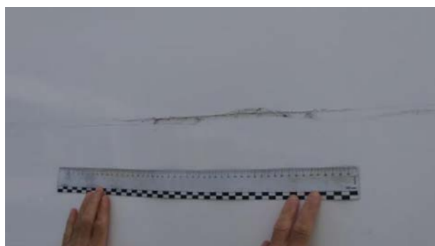
Bočni paneli: Ogrebotina sa uklanjanjem materijala \geq 20 cm u okviru ekonomične popravke. Opcija za farbanje pola panela
