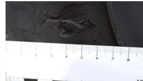
Pneumatici: Urez > 3 mm dubine, uklanjanje
