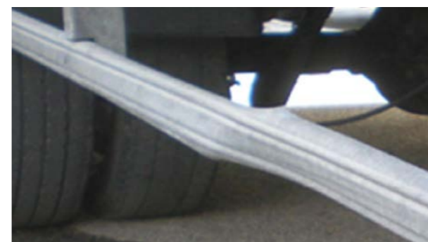
Nosači za bicikle: Deformacija van ekonomične popravke
