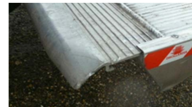
Utovarna platforma: Deformacije u platforme okviru ekonomične popravke
