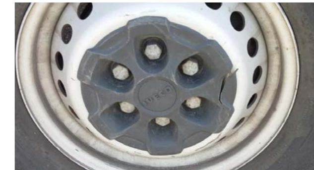
Felne: Deformisane, slomljene, materijal nedostaje ili je uklonjen
