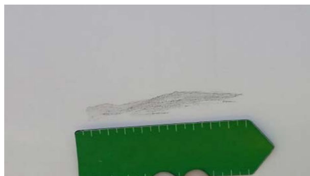
Bočni paneli: Bleda ogrebotina sa uklanjanjem materijala \leq 20 cm
