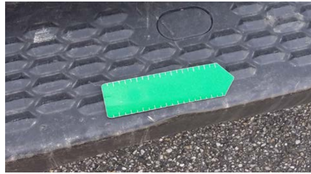
Bakramper: Lätt deformation
