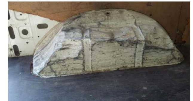
Invändig deformation: Perforeringar, skårer, deformationer bortom ekonomisk reparation. Denaturering och icke-korrigerbara fläckar (pulver, färg etc.) (Skärmkant ej återställningsbar om reparationstid < 3 h)
