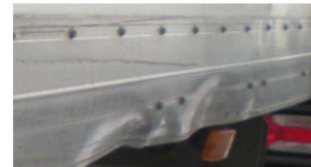
Bottenplattans sidoprofiler: Deformationer bortom ekonomisk reparation, perforeringar, borttagning av en profilsektion
