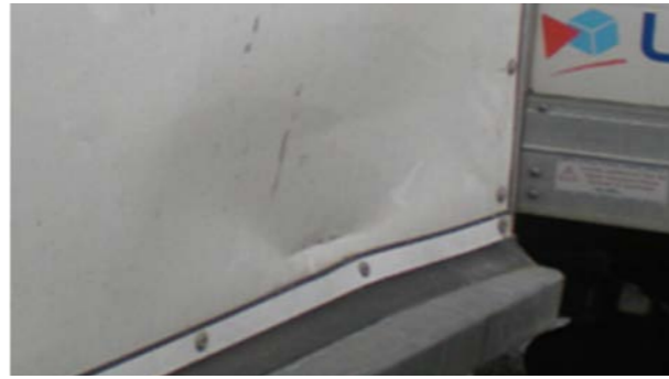
🔧 Sido- och bakdörrar: Signifikant deformation: Reparationstid > 1 h inom ekonomisk reparation, änden inte tätad
