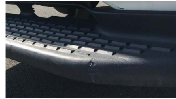
Bakramper: Deformationer med ekonomiskt genomförbara reparationer
