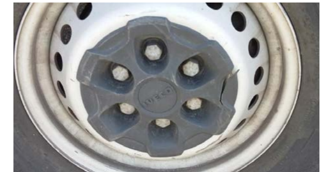
Hjulsidor: Deformerade, trasiga, saknat eller borttaget material
