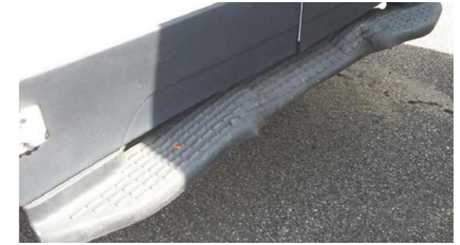
Bakramper: Deformationer utan ekonomiskt genomförbara reparationer
