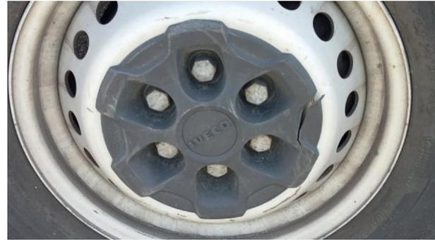
↻ Radabdeckungen: Verformt, gebrochen, Material fehlt oder entfernt
