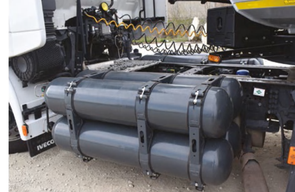
Posode za plin sprejmejo 200 kg stisnjene zemeljskega plina, kar v povprečnih pogojih zagotavlja avtonomijo 600–700 km.
