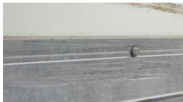
📋 Profiluri laterale șasiu: Zgârietură ușoară
