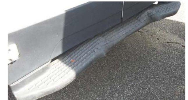
Trepte spate: Deformări care nu pot fi remediate prin reparații economice
