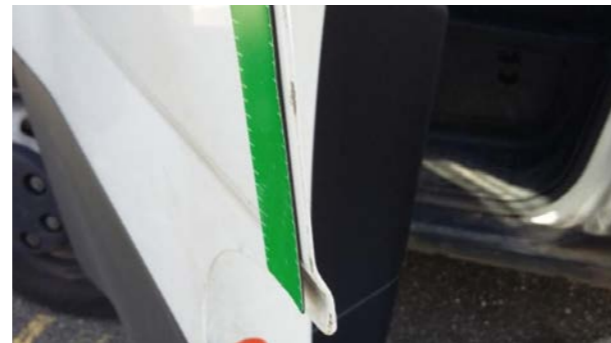
☰ Fisură pe marginea ușii
