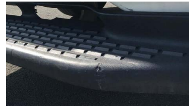
Trepte spate: Deformări care pot fi remediate prin reparații economice
