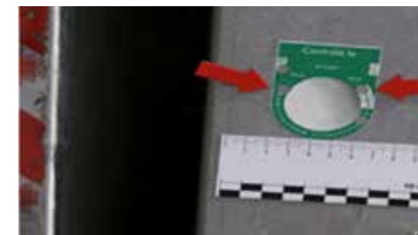
🔧 Ladebordwand: Prüfindervall überschritten
