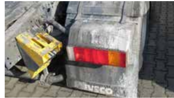
Starke Verfärbung durch chemische Elemente
