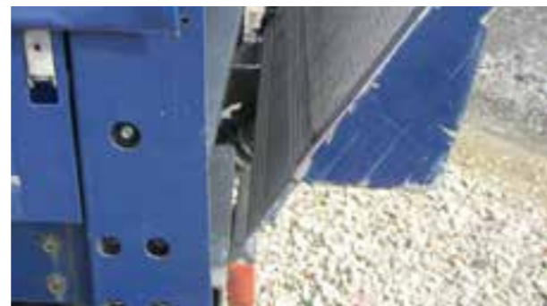
✂ Ladebordwand: Verformungen der Plattform, die auf wirtschaftliche Weise repariert werden können
