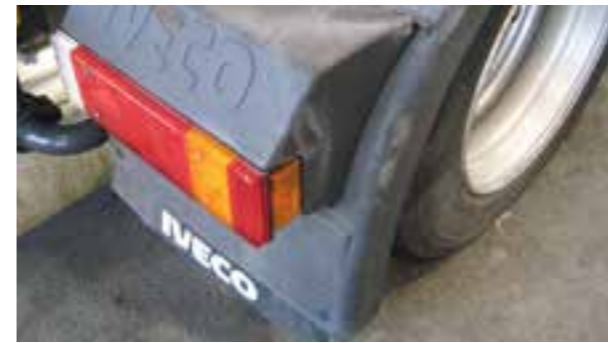
Tiefe Kratzer und Verformungen
