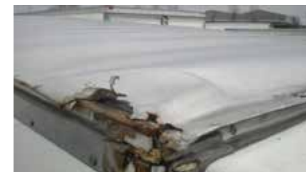
↻ Dachfläche: Rahmen beschädigt, Leder kann nicht auf wirtschaftliche Weise repariert werden
