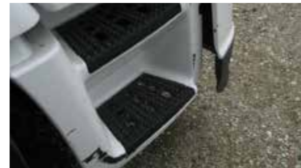
Rimozione di materiale, componente rotto
