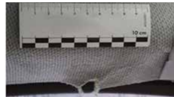
Profilati in tessuto e plastica: strappo, foro > 5 mm, segni indelebili
