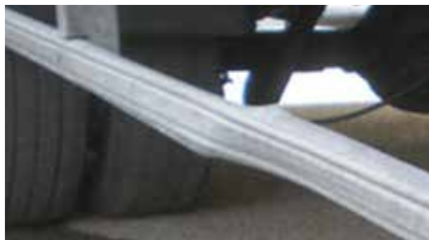
↻ Barre di protezione: deformazione dalla riparazione antieconomica
