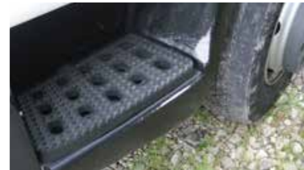
Graffi percettibili al tatto o superficie > 45 \text{ cm}^2 (l'equivalente di una carta di credito)
