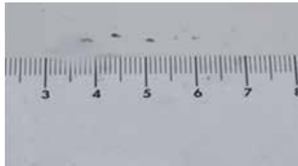
Poškodenie od kamienkov \leq 5 mm v priemere a \leq 20 poškodení
