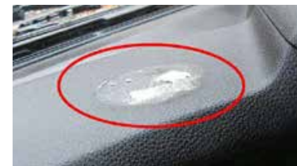
Látkové a plastové obloženie: trhlina, diera > 5 mm, neodstrániteľné škvrny
