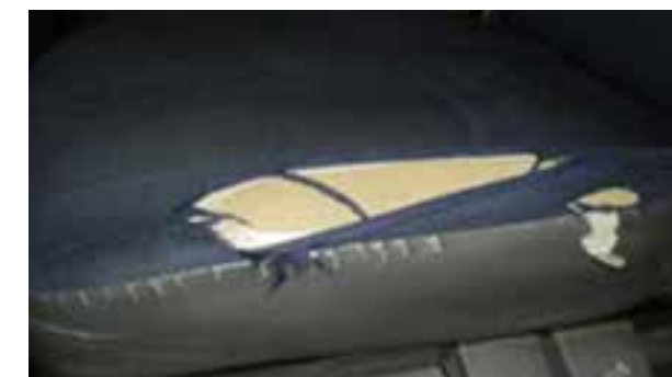
Prepálenie > 3 mm, perforácia alebo trhlina v krytine, bez poškodenia peny
