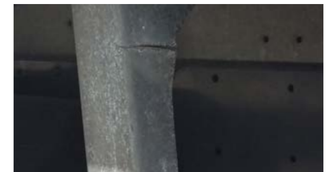
Zadní nakládací plošina: deformace plošiny v mezích odpovídajících ekonomičnosti opravy
