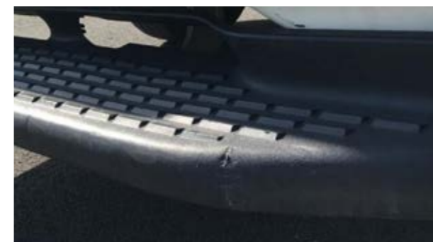
Zadní schůdek: deformace v rámci ekonomičnosti opravy
