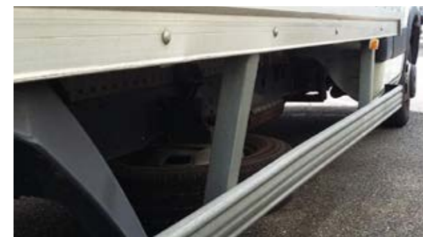
Boční ochrana: deformace rámci ekonomičnosti opravy
