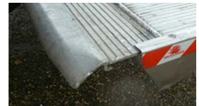
Zadní nakládací plošina: deformace plošiny v mezích odpovídajících ekonomičnosti opravy
