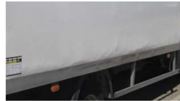
Laminátové boční panely: deformace spodní části, délka > 1 m Poznámka: výměna předního panelu podvozku vyžaduje demontáž spodní části karosérie.
