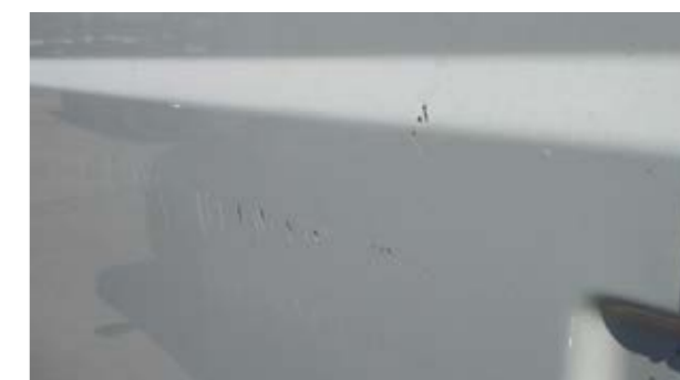
Škrábance > 20 mm Poznámka: na zadních výklopných dveřích není možné lakovat polovinu panelu
