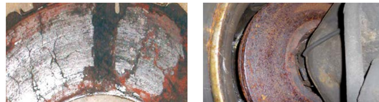
Zkorodované, obroušené, opotřebované brzdové kotouče
