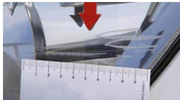
Hluboký škrábanec (s odstraněním materiálu), vně světelného pole a těsnění světla
