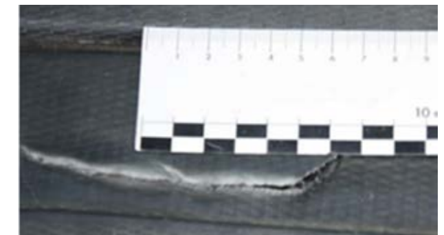
Perforace tvrdých plastových profilů. Oprava tvrdých plastových profilů v rozsahu 1 hodiny paušální sazby, pokud je to esteticky přijatelné a opravitelné
