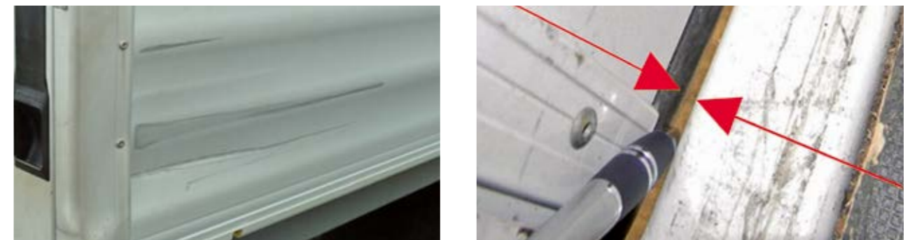
Deformace uzavření karosérie není nad rámec ekonomičnosti opravy, uzavření nelze provést, popřípadě nedostatečné utěsnění proti vniknutí písku
