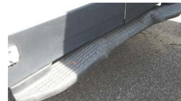
Zadní schůdek: deformace nad rámec ekonomičnosti opravy
