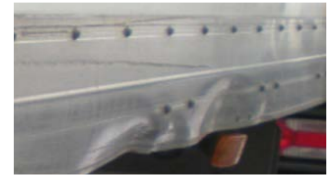
Boční profily nadstavby: deformace nad rámec ekonomičnosti opravy, perforace, demontáž části profilu
