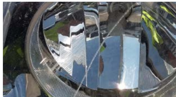
Škrábanec ve světelném poli, prasklina, kondenzace, zlomené nebo rozbité upevnění
