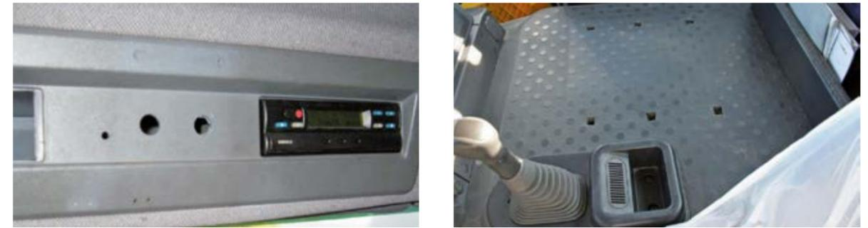
Componenti di comando, componenti del sedile o del rivestimenti mancanti, rotti o forati
