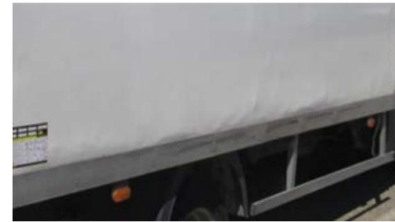
Fiancate in fibra: Deformazione nella parte inferiore, lunghezza  $> 1$  m
