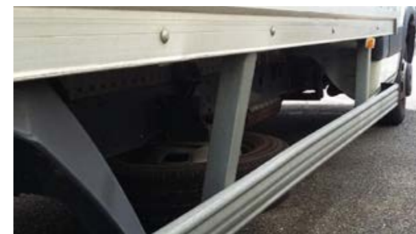
Bočná ochrana: deformácia v rámci ekonomickej opravy
