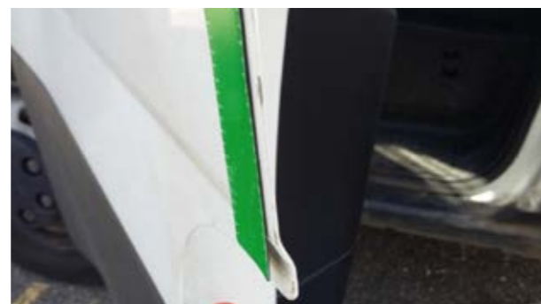
Poškodenie na okraji dverí
