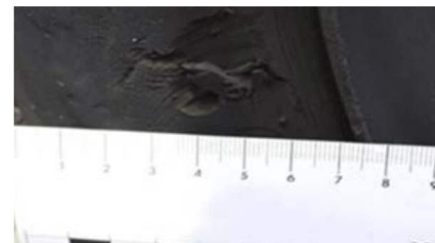
Pneumatiky: dezén \leq 3 mm hĺbky, odstránenie
