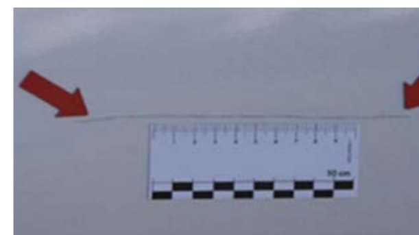
Škrabance > 20 mm Pozn.: na zadných výklopných dverách nie je možné lakovať polovicu panela.
