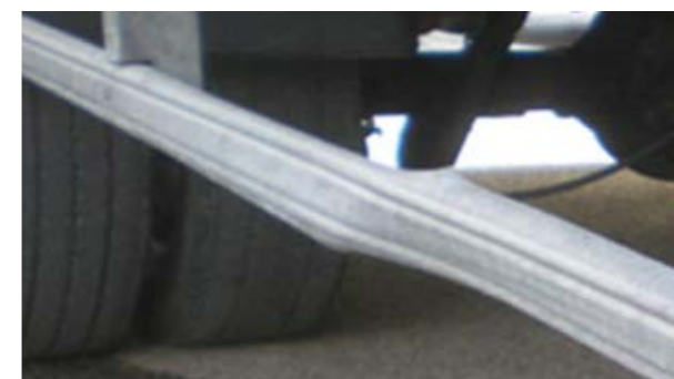
Bočná ochrana: deformácia, ktorá nie je súčasťou ekonomickej opravy
