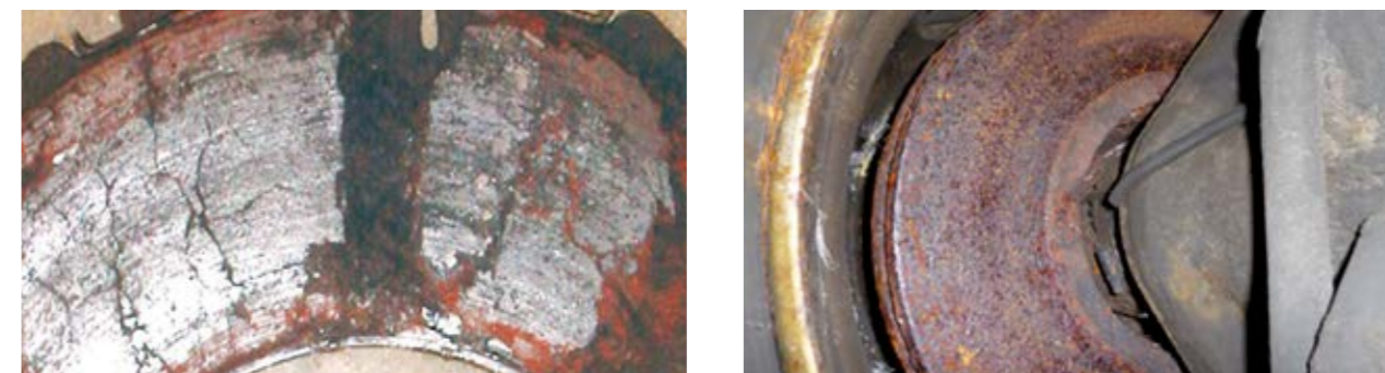
Hrdzavé, obrúsené, opotrebované brzdové kotúče
