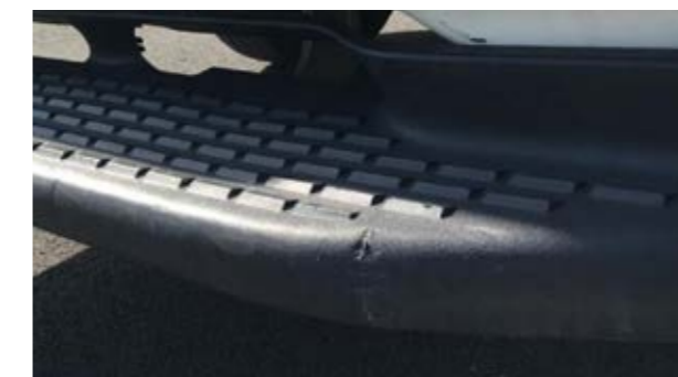
Zadný schodík: deformácie v rámci ekonomickej opravy
