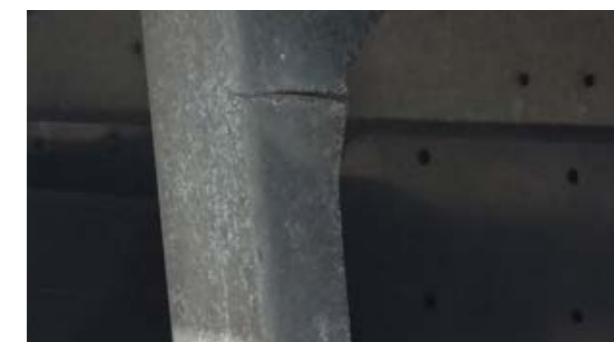
Bočná ochrana: deformácia, ktorá nie je súčasťou ekonomickej opravy
