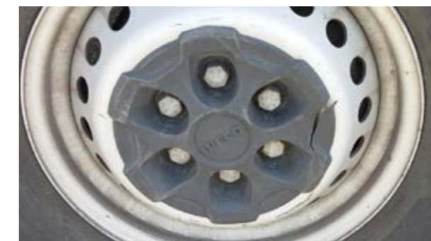
Kryty kolies: deformované, zlomené, chýbajúci materiál alebo odstránené
