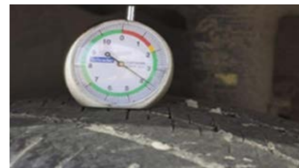
Pneumatiky: základ hĺbky dezénu < 5 mm Poznámka: opotrebovanie pneumatík sa meria v drážke pneumatiky, ktorá vykazuje najväčšie opotrebovanie.
