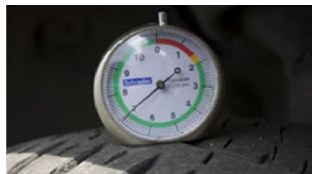
Pneumatiky: základ hĺbky dezénu \geq 5 mm (VYHOVUJE) Poznámka: opotrebovanie pneumatík sa meria v drážke pneumatiky, ktorá vykazuje najväčšie opotrebovanie.
