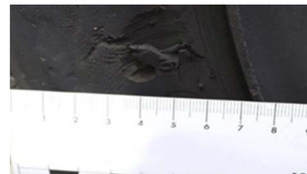
Reifen: Beschädigungen > 3 mm, abgetragen
