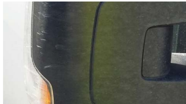
📋 Kratzer \leq 45 \text{ cm}^2 (entspricht der Fläche einer Kreditkarte), und die mit dem Fingernagel nicht zu spüren sind
