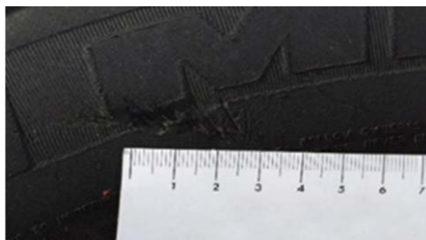
Reifen: Beschädigungen \leq 3 mm (ERFÜLLT)
