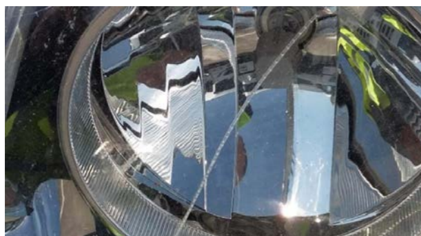
Kratzer im Ausleuchtungsfeld, Risse, Kondensation, gebrochen, oder gebrochene Halterung
