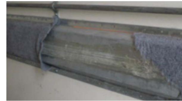
Polsterung und Stangen: Teppich gerissen oder abgelöst
