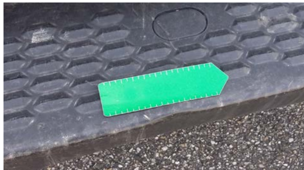
Hintere Trittbretter: Leichte Verformung
