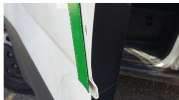
Lackschaden an Türkante
