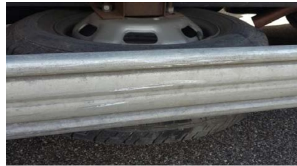
Seitenunterfahrerschutz: Leichte Kratzer
