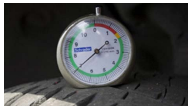
Reifen: Profiltiefe \geq 5 mm (ERFÜLLT) Anmerkung: Der Reifenverschleiß wird in der am meisten abgenutzten Profilrille am Reifen gemessen.
