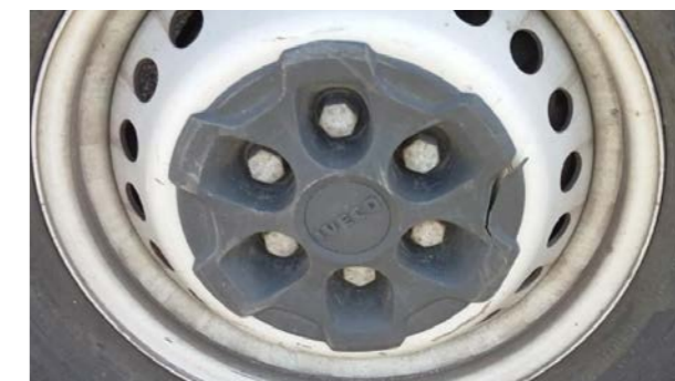
Radabdeckungen: Verformt, gebrochen, Material fehlt oder entfernt
