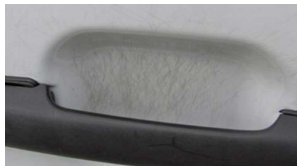
📋 Leichte oberflächliche Kratzer, z. B. an Tankdeckel, Klappen, Türgriffen, Stoßfängern und Verkleidungen
