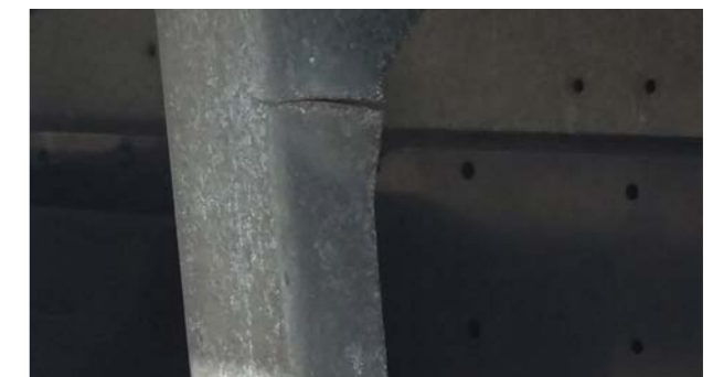
Seitenunterfahrerschutz: Deformationen, die nicht auf wirtschaftliche Weise repariert werden können
