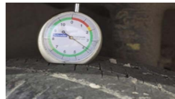
Reifen: Profiltiefe < 5 mm Anmerkung: Der Reifenverschleiß wird in der am meisten abgenutzten Profilrille am Reifen gemessen.
