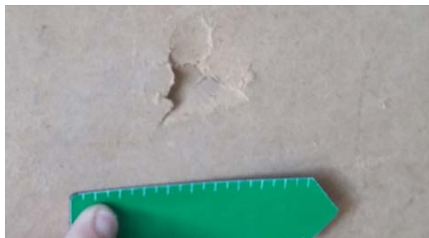
Innenraumverkleidung : Kleine Stoßspuren
