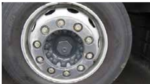
Ratlankiai ir ratų gaubtai: daugybiniai paviršiaus įbrėžimai su medžiagos pašalinimu ir be jo
