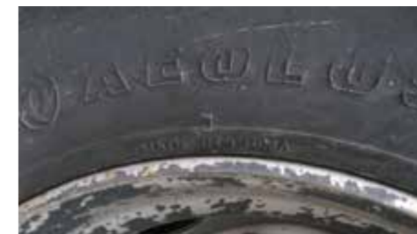
Padangos: griovelio gylio pagrindas < 7 mm Pastaba: padangų nusidėvėjimas matuojamas pagal labiausiai nusidėvėjusį padangos griovelį.
