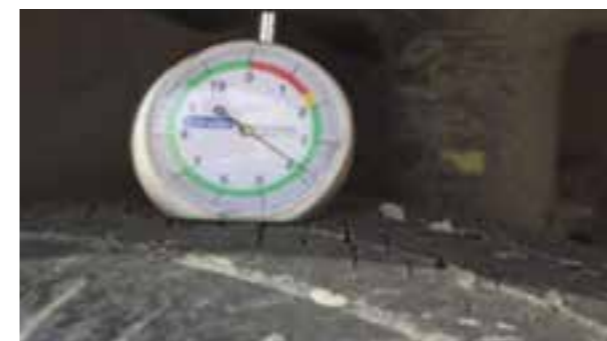
Padangos: griovelio gylio pagrindas < 7 mm Pastaba: padangų nusidėvėjimas matuojamas pagal labiausiai nusidėvėjusį padangos griovelį.
