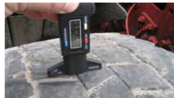
Pneumatici: Urez > 3 mm dubine, uklanjanje
