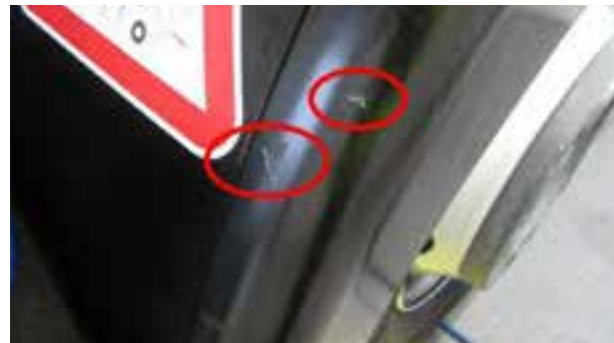
Ogrebotine koje se ne mogu osetiti pod noktima i površina \leq 45 \text{ cm}^2 (jednaka kreditnoj kartici)
