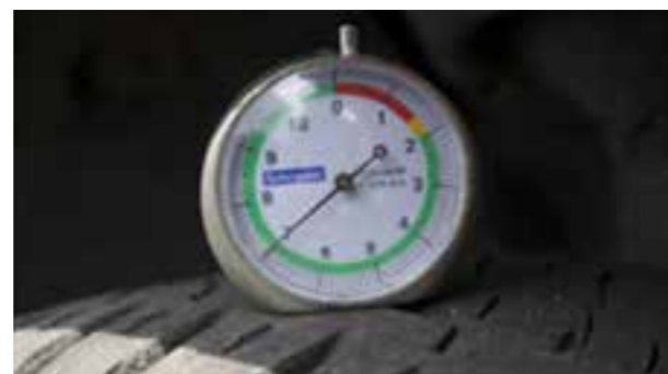
Pneumatici: Osnova dubine žleba \geq 7 mm (USAGLAŠENO) Napomena: Pohabanost pneumatika se meri na najviše pohabanom žlebu pneumatika.
