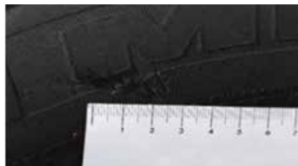
Pneumatici: Urezi \leq 3 mm dubine (USKLAĐENO)
