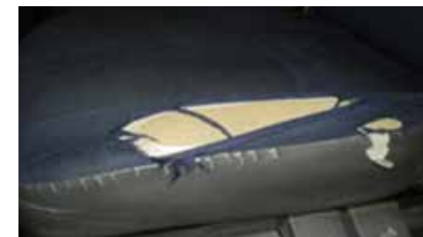
Opekotina > 3 mm, perforacija ili rascep na poklopcu, bez propadanja pene
