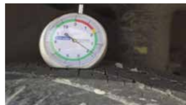
Pneumatici: Osnova dubine žleba < 7 mm Napomena: Pohabanost pneumatika se meri na najviše pohabanom žlebu pneumatika.
