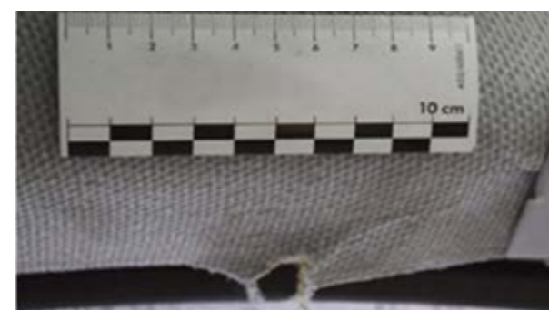
Fabrička obloga: Rascep, otvor > 5 mm, neizbrisivi tragovi
