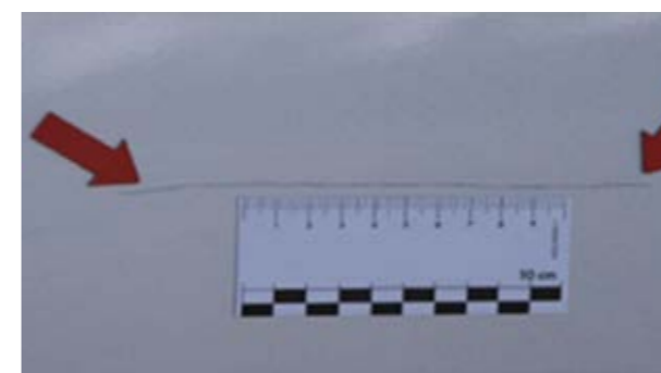
Ogrebotine > 20 mm NB: Na zadnjim nižućim vratima nije moguće farbanje pola panela
