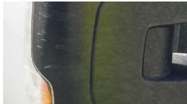
Ogrebotine koje se ne mogu osetiti pod nohtima i površina \leq 45 \text{ cm}^2 (jednaka kreditnoj kartici)
