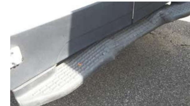
Zadnje platforme stepenika: Deformacije koje nisu u okviru ekonomične popravke
