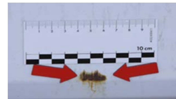
Ogrebotine sa oksidacijom, hemijske naslage ili drugo što se ne može očistiti
