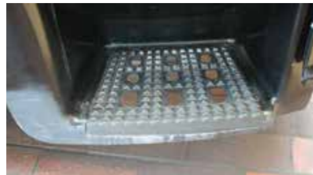
Graffi di lieve entità sulla vernice nei bordi di carico
