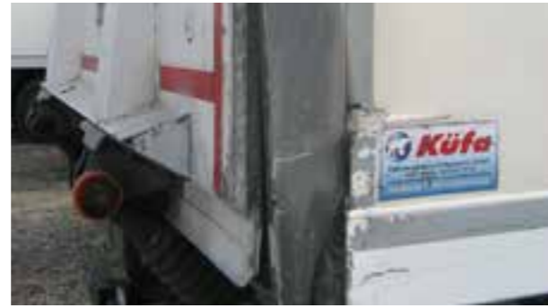
🔧 Porte laterali e posteriori: deformazione rilevante: tempo di riparazione > 1 h e riparazione economicamente conveniente, chiusura non a tenuta
