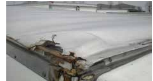
🔄 Padiglione: telaio danneggiato, pelle dalla riparazione antieconomica
