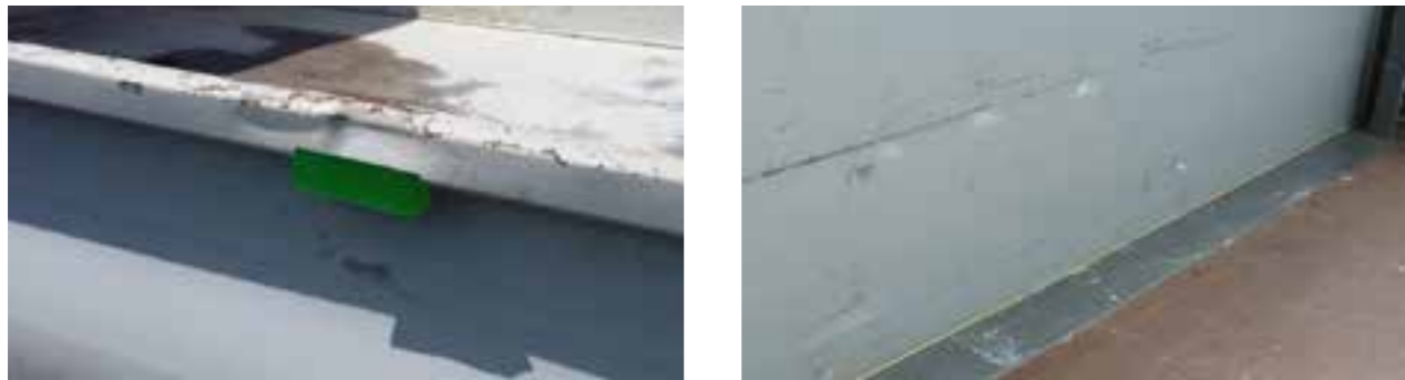
Graffi di lieve entità, deformazioni nelle sponde con tempi di riparazione \leq 1 h
