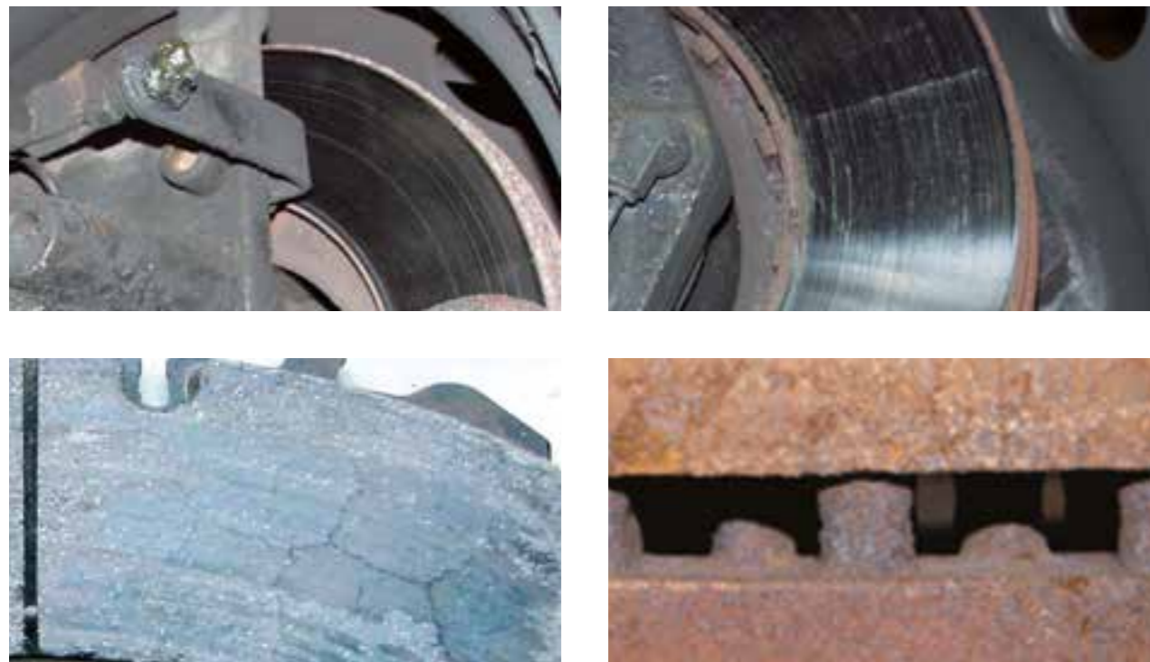
Condizioni normali e conformi all'età e al chilometraggio del veicolo Spessore dei pattini freno > 30 %
