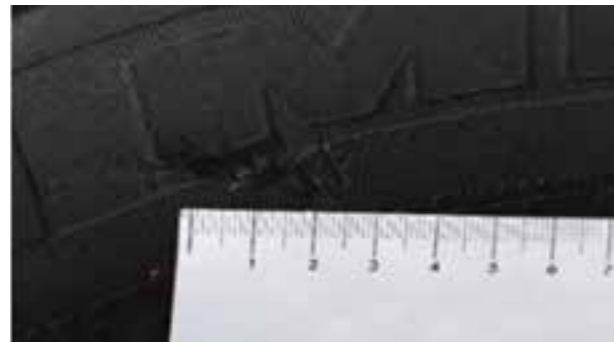
Pneumatici: tacca \leq 3 mm di profondità (CONFORME)
