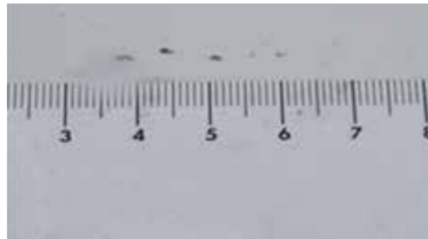
Scheggiature \leq 5 mm di diametro e \leq 20 di numero
