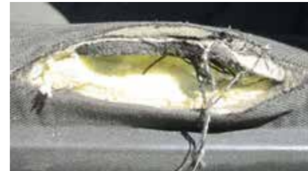
Schiuma mancante o telaio rotto
