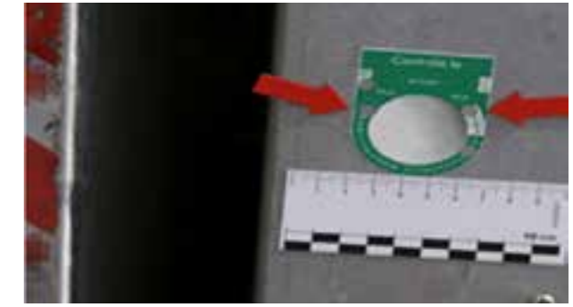
🔧 Sponda caricatrice: date di controllo scadute
