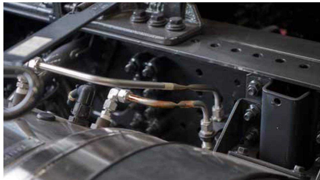
Presenza di ruggine, ammaccature, rotture e/o intagli → importo relativo alla sostituzione delle tubazioni rigide.
