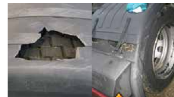
Отстранување на материјал, скршен дел
