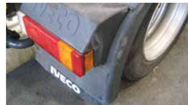
Длабоки гребнатини и деформации
