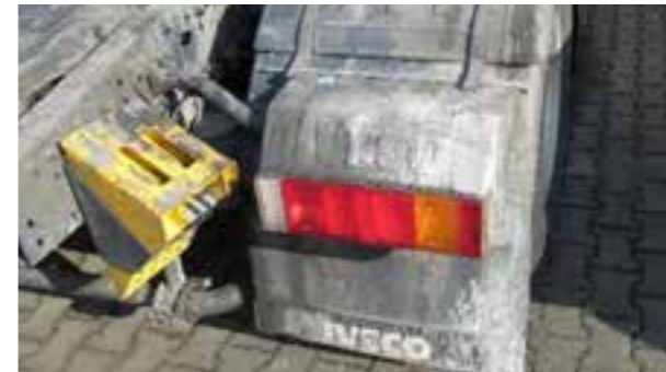
Głębokie przebarwienia z powodu pierwiastków chemicznych
