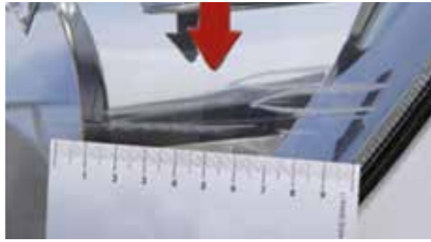
Risco profundo (com remoção de material), fora do campo de iluminação e luz selada
