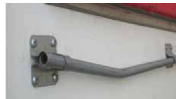
🔧 Estofos e hastes: hastes e estofos deformados dentro da reparação económica
