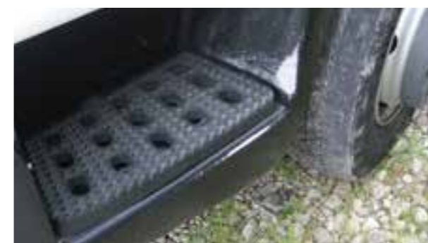
Riscos perceptíveis com a unha ou superfície > 45 \text{ cm}^2 (equivalente a um cartão de crédito)
