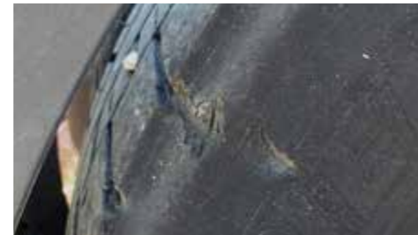
Pneus: entalhe > 3 mm de profundidade, remoção
