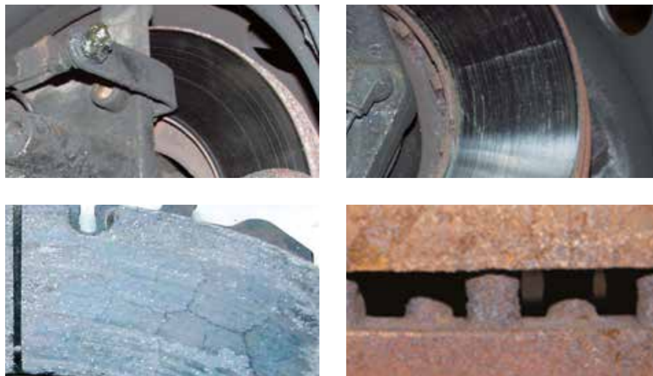
Estado normal e em conformidade com a idade e a quilometragem do veículo Espessura das pastilhas dos travões > 30 %
