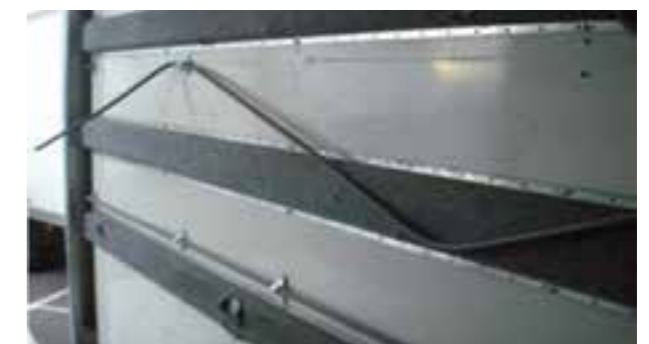
⌚ Estofos e hastes: hastes, fixações, estofos em falta ou deformados excedem a reparação económica
