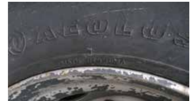
Pneus: piso com, profundidade < 7 mm Nota: o desgaste dos pneus é medido na ranhura mais gasta do pneu.
