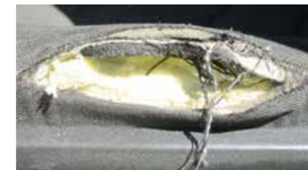
Falta da espuma ou estrutura partida
