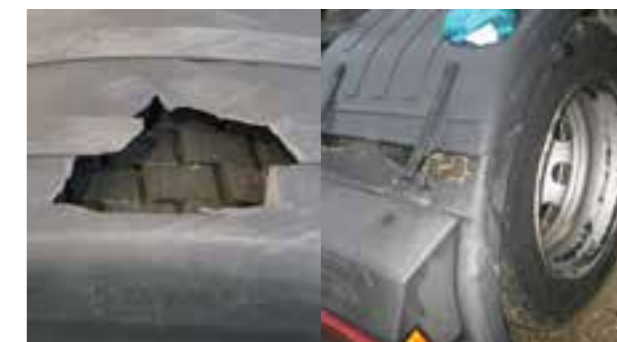
Material îndepărtat, piesă ruptă
