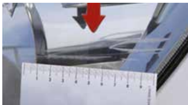
Zgârietură adâncă (cu material îndepărtat), pe lângă câmpul de iluminare și carcasa lămpii
