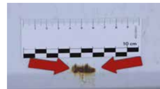
Zgârieturi apărute prin oxidare, depuneri chimice sau din alte cauze, care nu pot fi curățate
