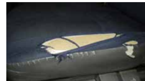
🔄 Arsură > 3 mm, perforare sau ruptură a stratului, fără deteriorarea spumei
