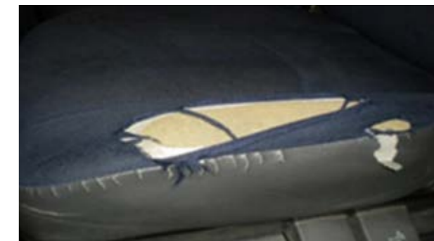
Pregoreno > 3 mm, perforacija ili kidanje pokriva, nema oštećenja pjene
