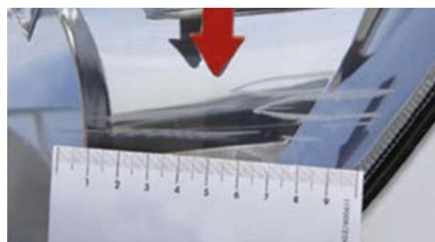
🔍 Duboke ogrebotine (s uklanjanjem materijala), izvan područja svjetala i zabrtvljenih svjetala
