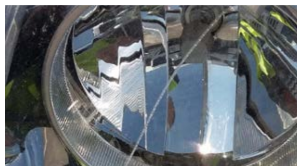
🔄 Ogrebotine na polju osvjetljenja, pukotine, kondenzacija, puknuće ili puknuto pričvršćenje
