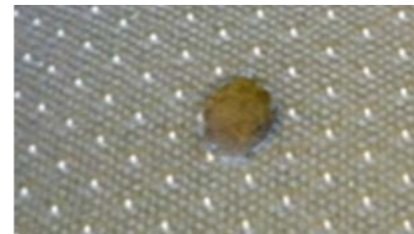
Pregoreno > 3 mm, perforacija ili kidanje pokriva, nema oštećenja pjene
