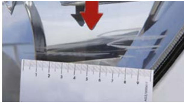
🔍 Głębokie zadrapanie (z ubytkiem materiału), poza polem świecenia, światło szczelne
