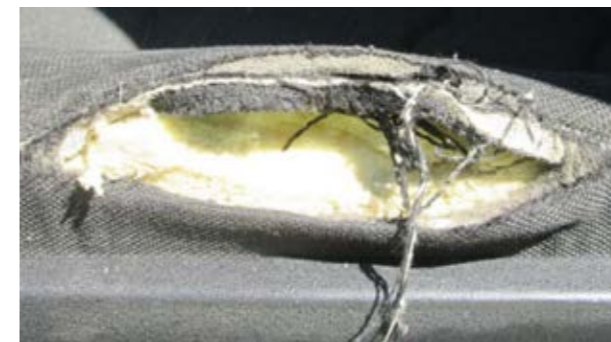
Brak pianki lub złamanie ramy
