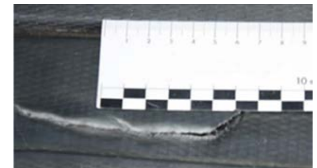
Perforacja elementów wykończeniowych z twardego plastiku. Naprawa elementów wykończeniowych z twardego plastiku za zryczałtowaną stawkę godzinową, pod warunkiem, że jest akceptowalna pod względem estetycznym i wykonalna
