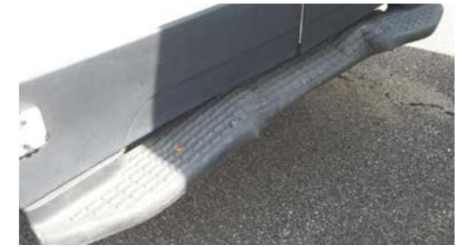
Tylne stopnie do wchodzenia: Odkształcenia, których naprawa jest nieopłacalna
