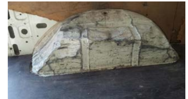
Odkształcenia wewnętrzne: Perforacje, nacięcia, odkształcenia, których naprawa jest nieopłacalna. Zmiany i ślady substancji niemożliwe do usunięcia (proszek, lakier itp.) (Nadkole nie do naprawy, jeśli czas naprawy < 3h)
