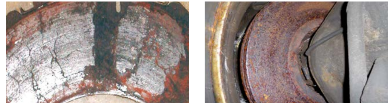
Zardzewiałe, zużyte tarcze hamulcowe
