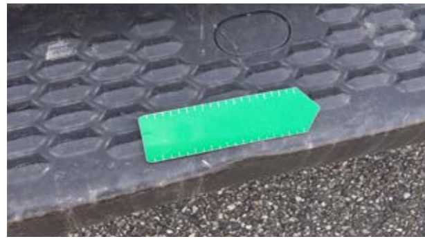
Tylne stopnie do wchodzenia: Niewielkie odkształcenia
