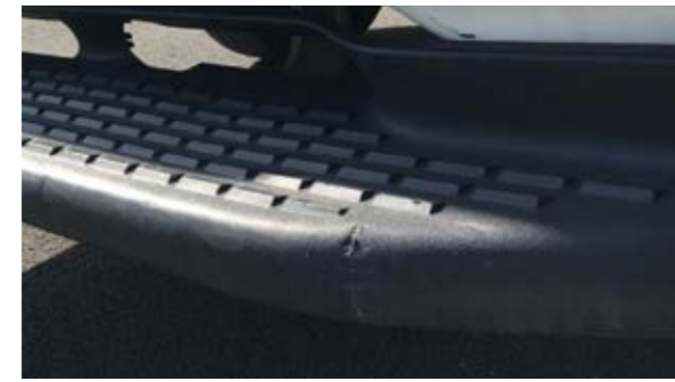
Tylne stopnie do wchodzenia: Odkształcenia, których naprawa jest opłacalna
