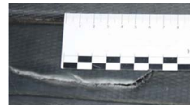
Perfuração de revestimentos de plástico duro.
