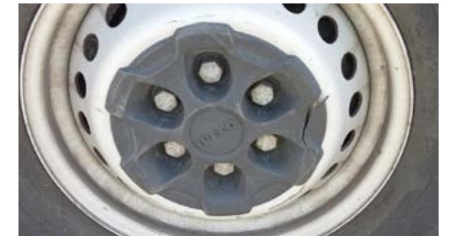
Tampões das rodas: deformados, partidos, material ou falta ou removido
