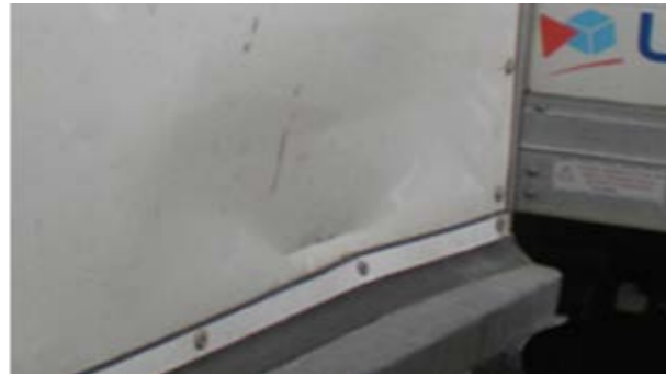
🔧 Portas laterais e traseiras: deformação significativa: tempo de reparação > 1 h dentro da reparação económica, fecho não selado
