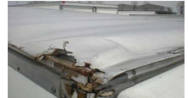
↻ Espaço do tejadilho: estrutura danificada, fora da reparação económica
