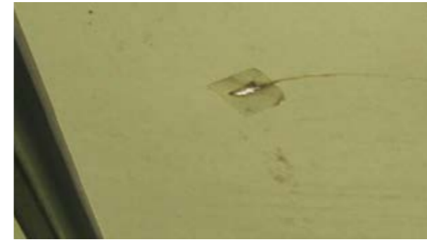
🔧 Espaço do tejadilho: perfurado ou rasgado dentro da reparação económica
