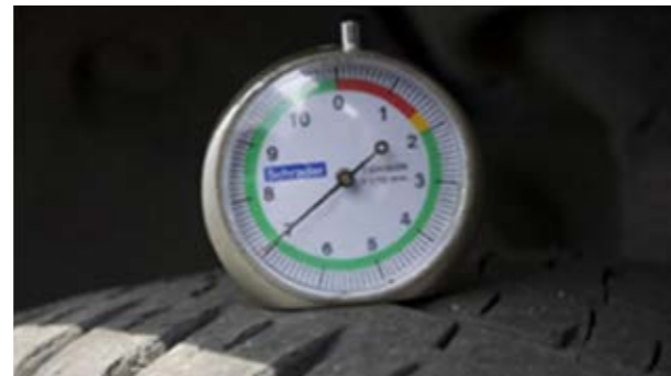
Pneus: base da ranhura, profundidade \geq 5 mm (CONFORME)
