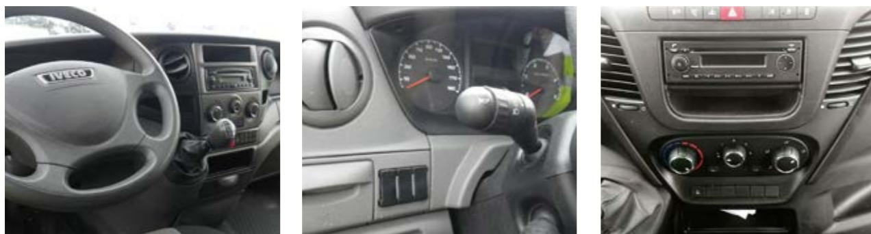
Sinais de desgaste no painel de instrumentos e no volante
