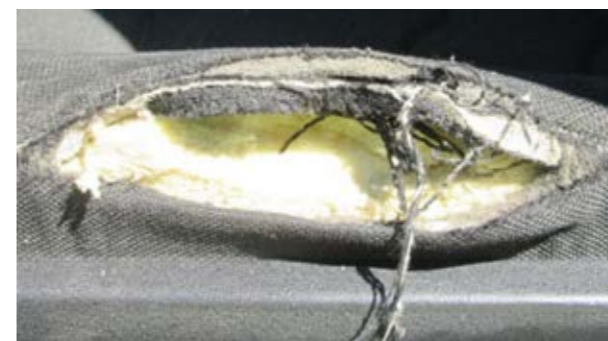
Falta da espuma ou estrutura partida
