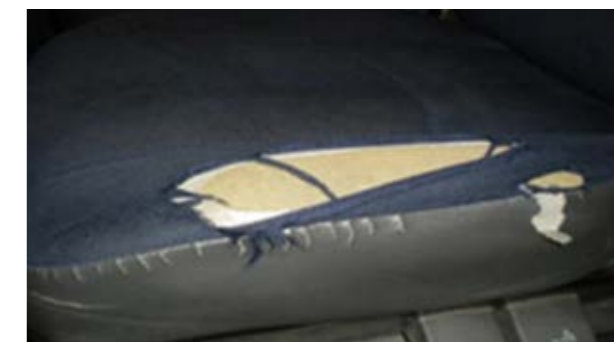
Queimadura > 3 mm, perfuração ou rasgo na tampa, sem deterioração da espuma
