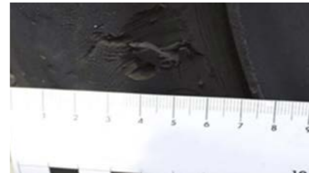
Pneus: entalhe > 3 mm de profundidade, remoção
