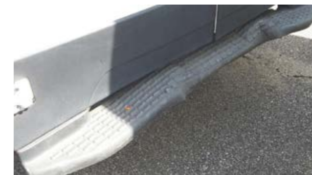
Plataformas traseiras: deformações fora da reparação económica
