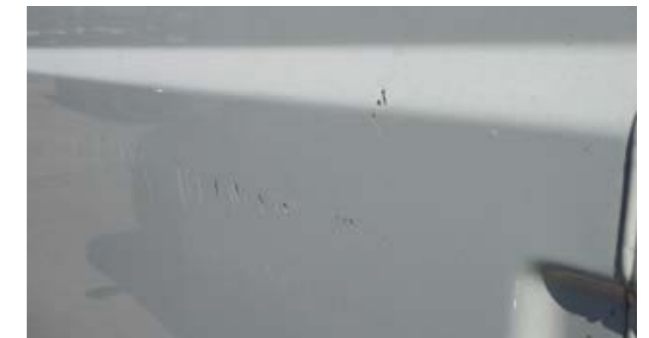
Riscos com oxidação, depósitos químicos ou outros que não podem ser limpos
