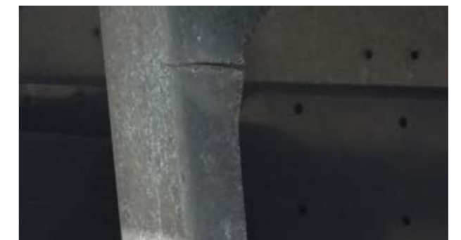
Suportes para bicicletas: deformação que excedem a reparação económica
