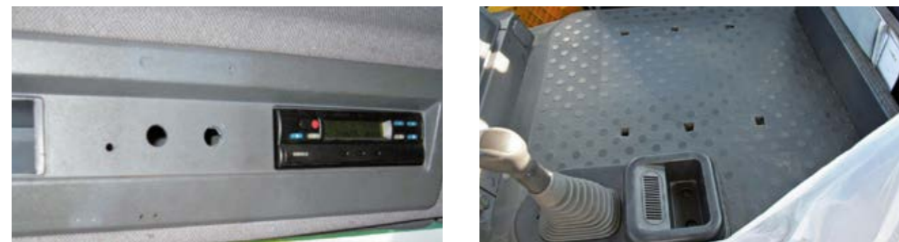
Peças de comando, peças do banco ou do revestimento em falta, partidas ou perfuradas
