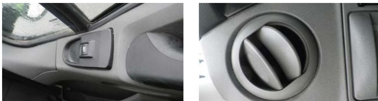
Descoloração ligeira devido aos raios de sol
