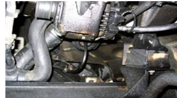
Scurgeri de la mecanismul de direcție și pompa de servodirecție
