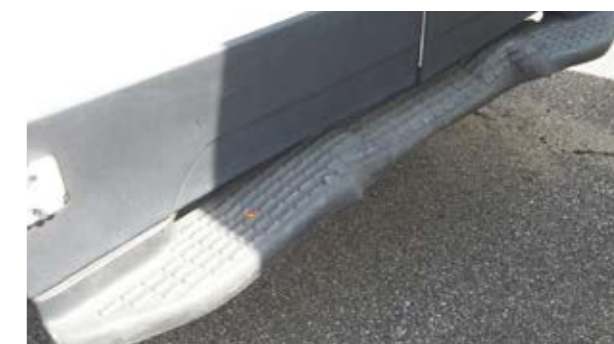
Trepte spate: Deformări care nu pot fi remediate prin reparații economice
