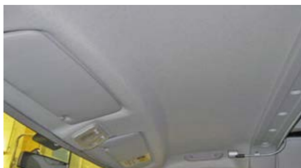
Decolorare ușoară din cauza razelor solare
