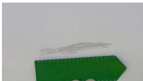
📋 Panouri laterale: Zgârietură ușoară cu material îndepărtat \leq 20 cm
