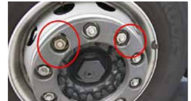
Wieloppen: Vervormd, gebroken, materiaal ontbreekt of compleet verwijderd
