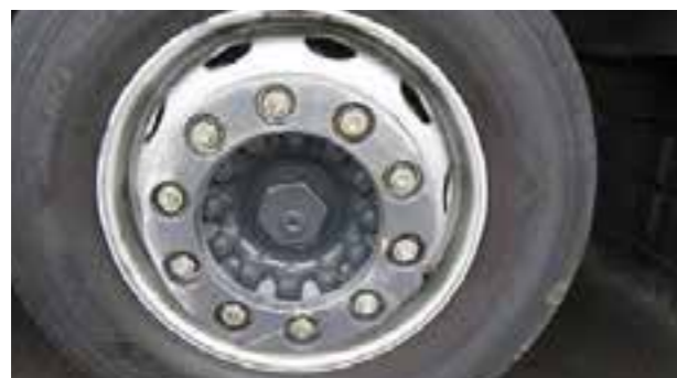
Velgen en wieloppen: Meerdere oppervlakkige krassen met of zonder verwijdering van materiaal
