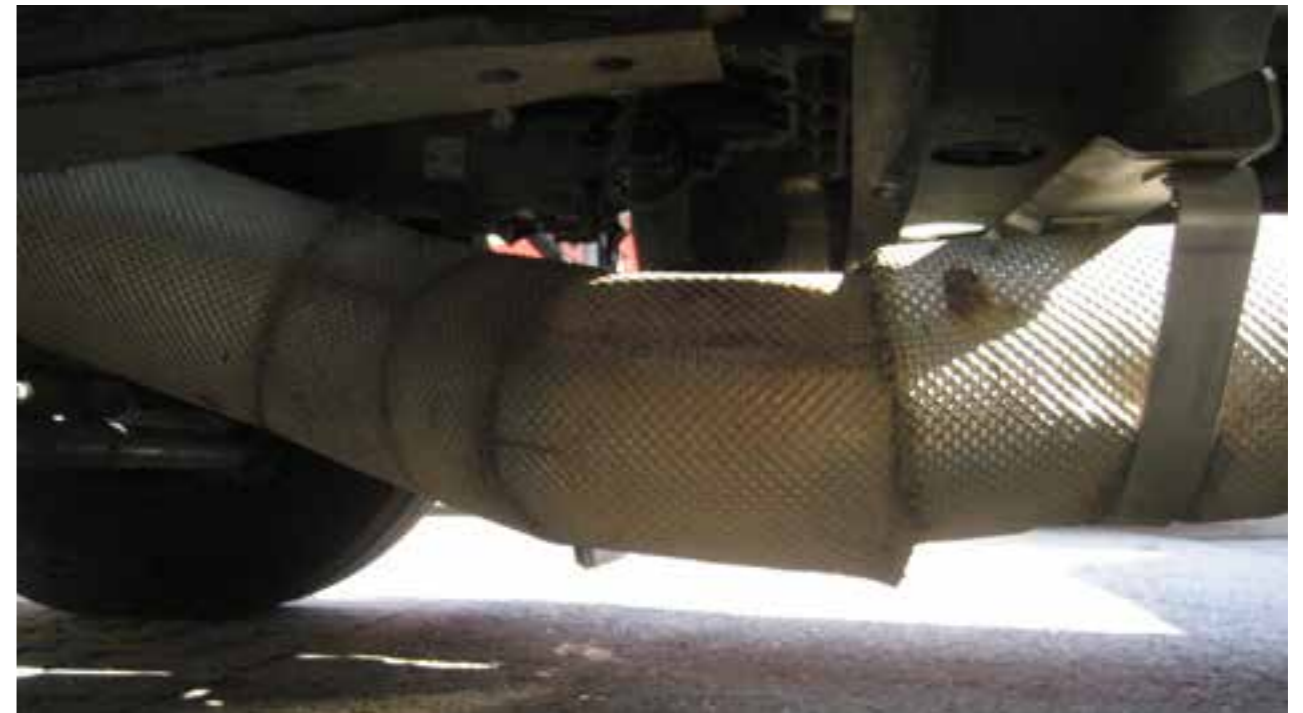
De volgende zaken zijn niet acceptabel: gebroken pijpen, gescheurde thermische isolatie, deuken die de diameter van de pijp beïnvloeden.
