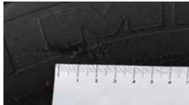
Banden: Inrijding \leq 3 mm diep (GEACCEPTTEERD)
