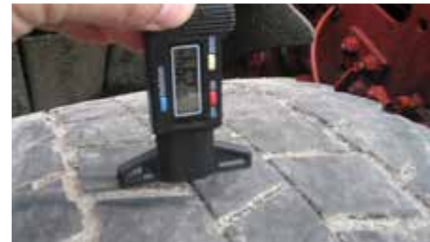
Banden: Inrijding > 3 mm diep, demontage
